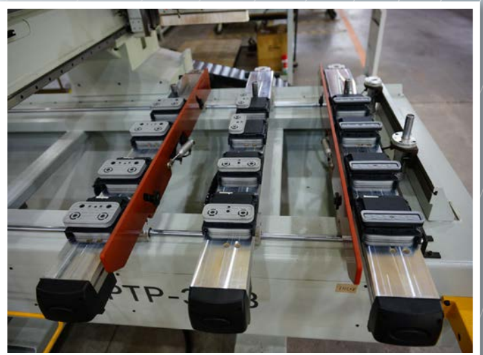
Werkstückhalterung – Flachtische mit Vakuumnuten sowie schienengeführte Systeme bieten flexible Aufspannmöglichkeiten.
